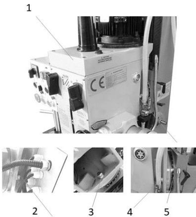
Der Maschinenkopf (1) lässt sich innerhalb der technischen Angaben schwenken.
