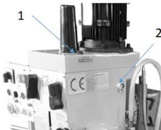
Schraube 1 entfernen. Öl auffüllen bei bis Ölschauglas bis zur Mitte befüllt ist. Maschinekopf muss dafür in senkrechter (0°) Position stehen. Anschließend Schraube 1 wieder montieren. Ölstand regelmäßig prüfen und bei Bedarf Getriebeöl nachfüllen!
