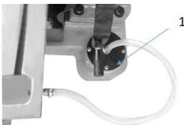
Das Kühlmittel wird an der Kühlmittelpumpe (1) eingefüllt – siehe Bild links.
