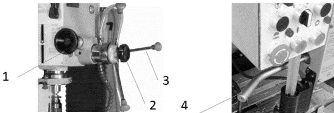
Der Spindelhub lässt sich durch Drehen des Hebels (3) nach unten/oben bewegen. Dazu muss der Fixierhebel (4) gelöst sein. Für die Feineinstellung wird Handschraube (2) festgezogen nun kann mittels dem Handrad (1) der Hub auf die gewünschte Höhe noch feineingestellt werden. Für das Blockieren der Spindel in der gewählten Position den Fixierhebel (4) festdrehen.
