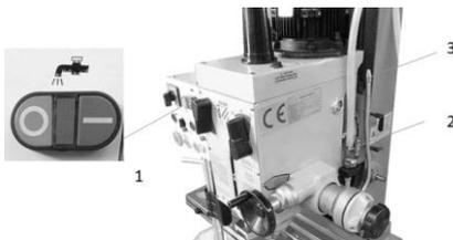
Die Kühlmittelpumpe wird mit dem Kühlmittel-Schalter (1) ein- und ausgeschaltet.
