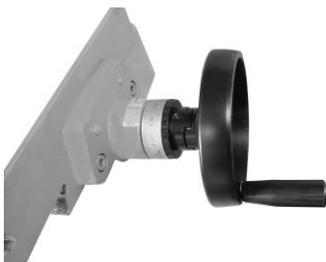
Sie können den Kreuztisch in X- und in Y-Richtung verschieben, um den Bohrer/Fräser an der richtigen Stelle zu positionieren.
