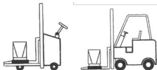
Transportieren Sie die Maschine in der Verpackung zum Aufstellort. Zum Manövrieren der Maschine in der Verpackung kann z.B. ein Paletten-Hubwagen oder ein Gabelstapler mit entsprechender Hubkraft verwendet werden.
