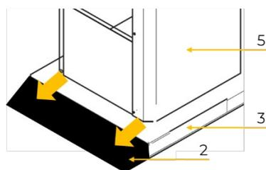
**HINWEIS:** Maschine nicht an den Arbeitstischen anheben, diese sind nicht dafür ausgelegt, der Zugbelastung durch das Maschinengewicht standzuhalten.
