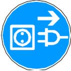
Vor Wartungsarbeiten oder Einstellarbeiten ist die Maschine von der Spannungsversorgung zu trennen! Verwenden Sie das Netzkabel nie zum Transport oder zur Manipulation der Maschine!
